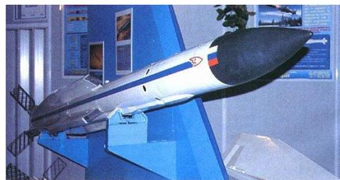
На ближнем рубеже обороны противника встретит ракета малой дальности К-МД (изд.300). Она оснащена матричной тепловой головкой самонаведения с возможностью распознавания образа и повышенной вдвое дальностью захвата. Силовая установка ракеты оснащена устройством газодинамического управления, что позволяет не только настичь высокоманевренный истребитель, но даже сбить подлетающую управляемую ракету.
